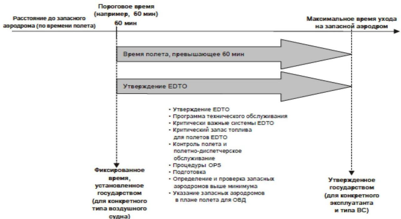
Рис. 9. Общая графическая схема EDTO для самолетов с двумя газотурбинными двигателями)
