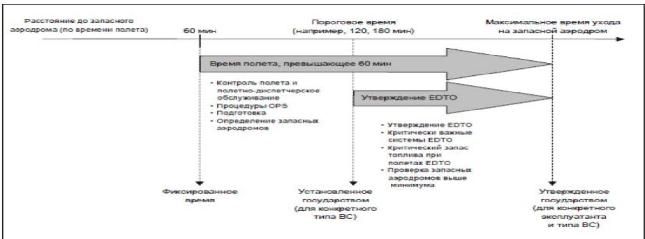
Рис.4. Общая графическая схема EDTO \ Figure 4. General graphical scheme of EDTO
