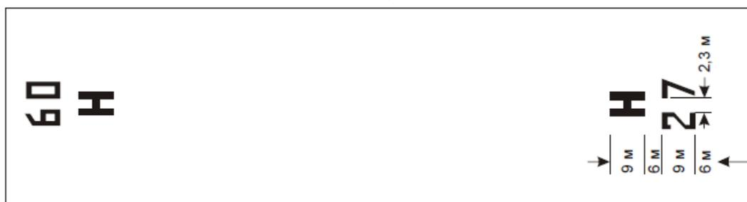
Рис. 5-4. Маркировка обозначения зоны FATO и вертодромная опознавательная маркировка для зоны FATO типа ВПП
