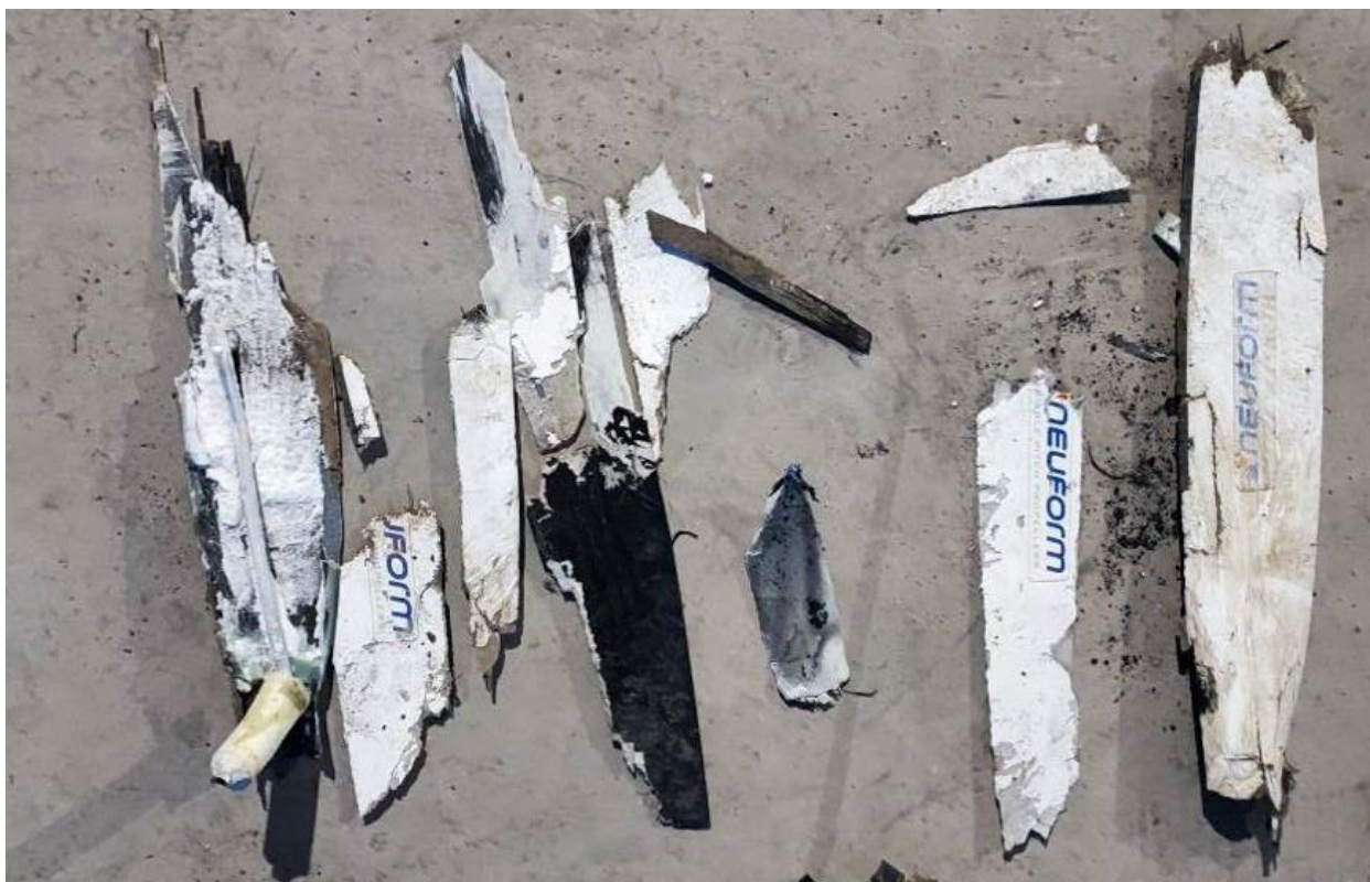
Рис. 2. Разрушение воздушного винта самолета Bristell NG-5RG EX-77019 после АП
