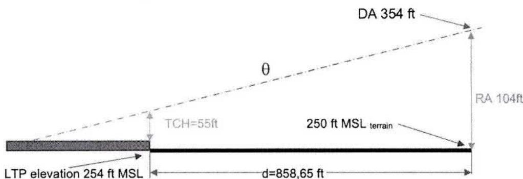
Минимумы высоты над зоной приземления на ВПП при заходе по барометрическому высотомеру или с использованием вертикального наведения (по глиссадному маяку) приведены в таблице 3
