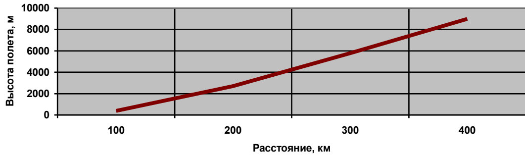
Рис. 1. График дальности действия двухсторонней авиационной радиосвязи с воздушным судном
