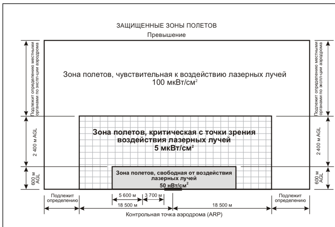
Рис. 5-16. Защищенные зоны полетов с указанием максимальных уровней излучения для видимых лазерных лучей
